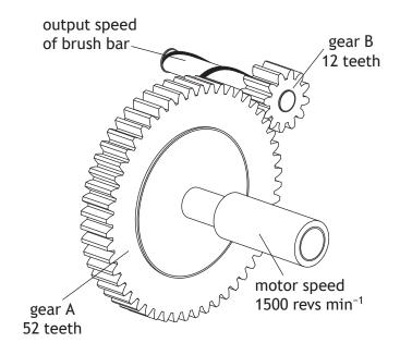
(d) Calculate the output speed of the brush bar.
