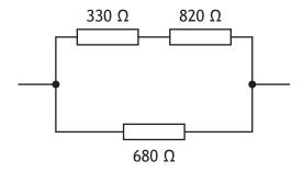
(d) Calculate the total resistance of the circuit above.
